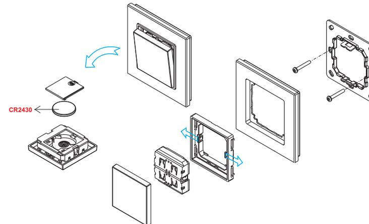
La partie clé de ce contrôleur est un élément de commutation standard universel et extrêmement rotatif qui peut être intégré dans Les nombreux cadres de différents fabricants sont les suivants:
